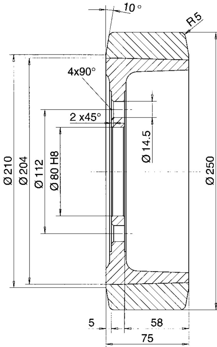
Tragfähigkeit: 1650 kg bis 6 km/h
