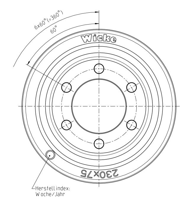
KTL-lackiert RAL 9005 Tiefschwarz Schichtdicke: 20 ±5 µm
